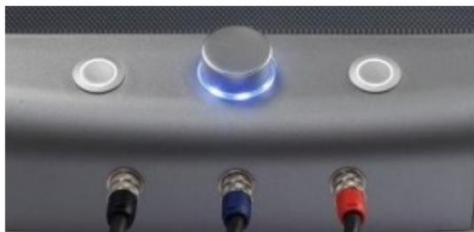
El disco central ajusta la potencia de salida del dispositivo.
