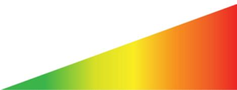
El triángulo colorado muestra una visualización en tiempo real del porcentaje de la energía utilizada y puede tomar colores variables del verde al amarillo en base al porcentaje de potencia que se está utilizando. Hasta el 30 % de la potencia el gráfico será verde, del 30 % al 60 % será amarillo y del 60 % en adelante rojo. Las transiciones entre un color y otro y por tanto entre una potencia y la otra, se crearán con gradaciones de color.
