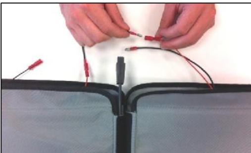
Conecte los conectores macho y hembra de la Mat 100 respectivamente con los conectores hembra y macho de la E-Mat 100
