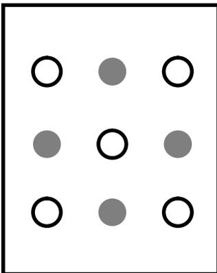
El esquema de al lado muestra la posición de las 4 bobinas (indicadas en gris) dentro de la esterilla.
